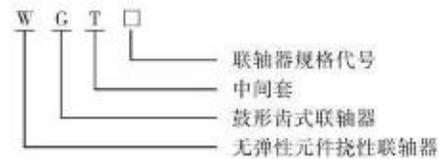
2.2 过盈配合油压装卸的无键联结的联轴器按 JB/T 6136 的规定，其标记方法，在轴孔直径前加“U”表示。
